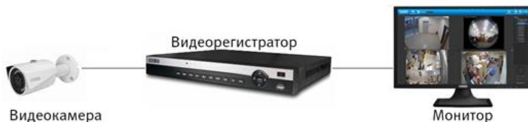
Рисунок 6.2 – Схема подключения видеокамеры
